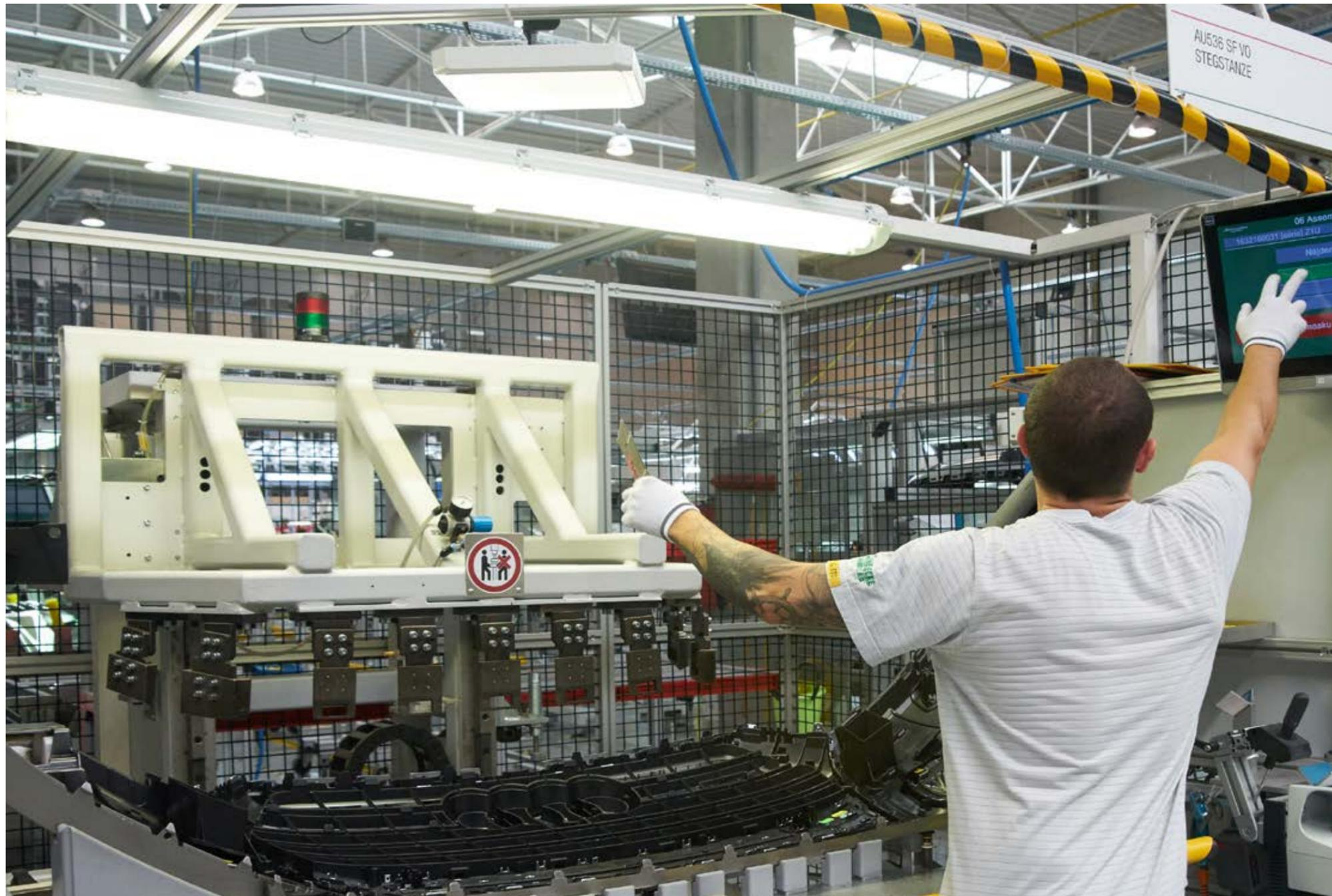
steckt, der nach der Endmontage einfach abgezogen werden kann. Über RFID („radio-frequency identification“) werden die Komponenten in den Montagebereich eingechekkt, und an jeder Montageinsel wird auf einem Bildschirm über dem Arbeitsplatz angezeigt, welche Teile anzubauen sind. Fehler der Monteure sind dadurch nahezu ausgeschlossen.
