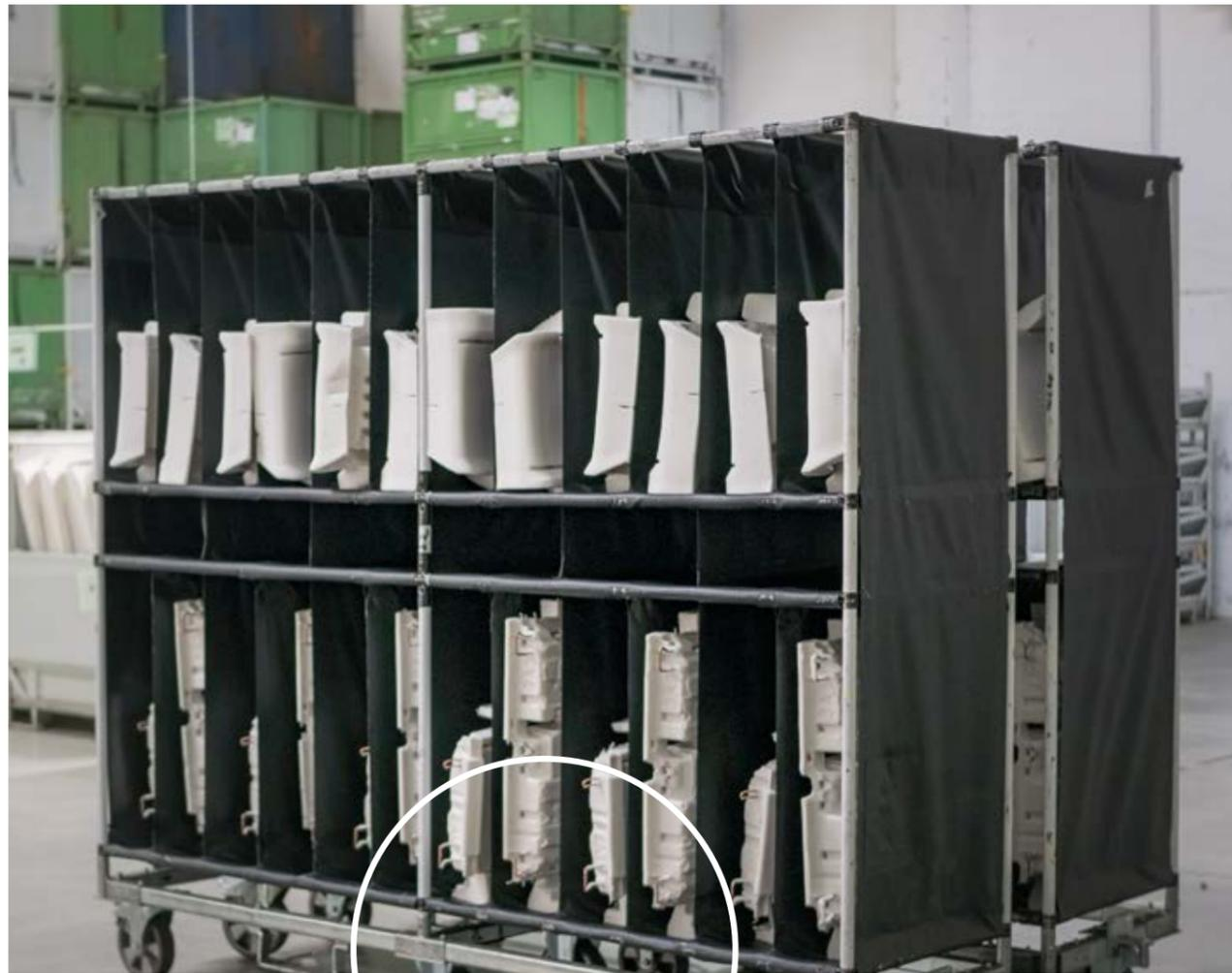
Bei Schnellecke sind seit diesem Jahr erstmals Behälter im Einsatz, die selbsttätig mitteilen, wo sie sich gerade befinden.
