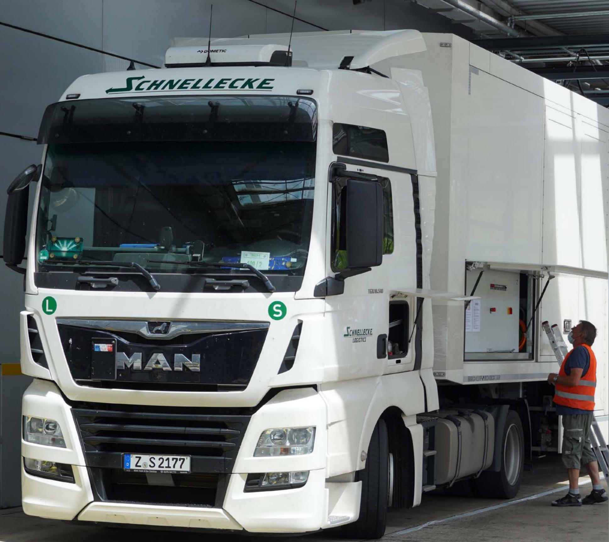
*Der Schnellecke Spezialtrailer entlädt seine Ladung automatisch in die Hebestation zum Karosseriepuffer.*
